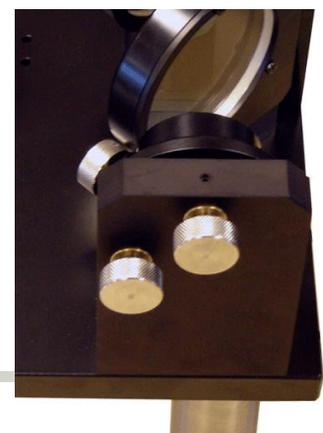
La compression du ressort spiral applique une contrainte sur le support porte miroir. La torsion qui en découle permet un ajustement très précis.
