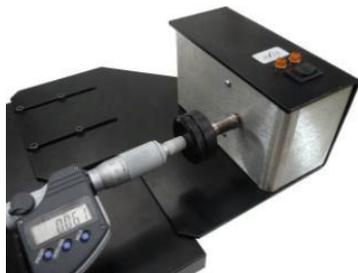
Le fonctionnement de l'interféromètre avec moteur interdit le balayage manuel. Lorsque le moteur est embrayé, le forçage manuel peut endommager tout ou partie de la motorisation. Nous vous conseillons de sensibiliser les élèves sur ce point.
