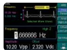
Regénération par le générateur série DG
